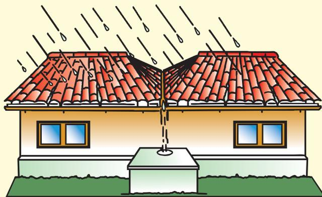
Vista simplificada de una estructura de captación y almacenamiento de agua. En este dibujo, para mejor ilustración, no se incluyó el entubado del agua de los canales hasta el reservorio.
