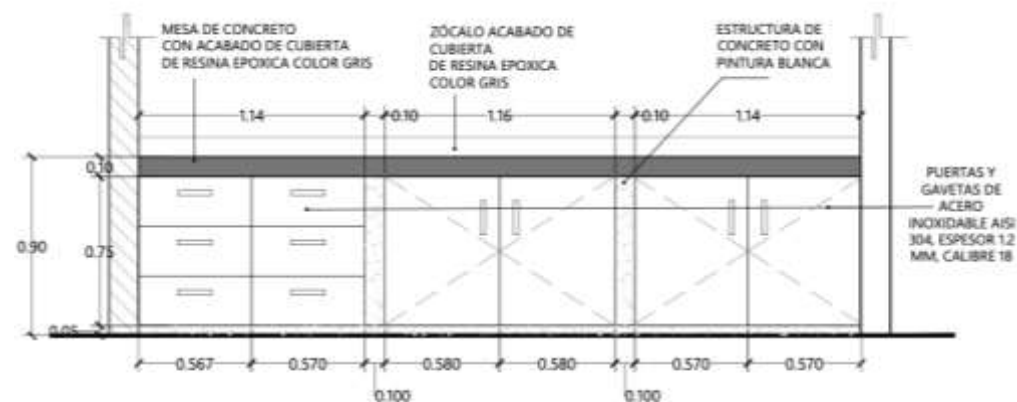
VISTA LATERAL CORTE A-A
