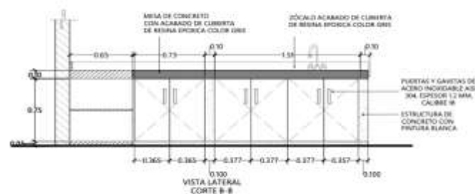
VISTA Y CORTES LAB. FITOPATOLOGIA ESC. 1:20
